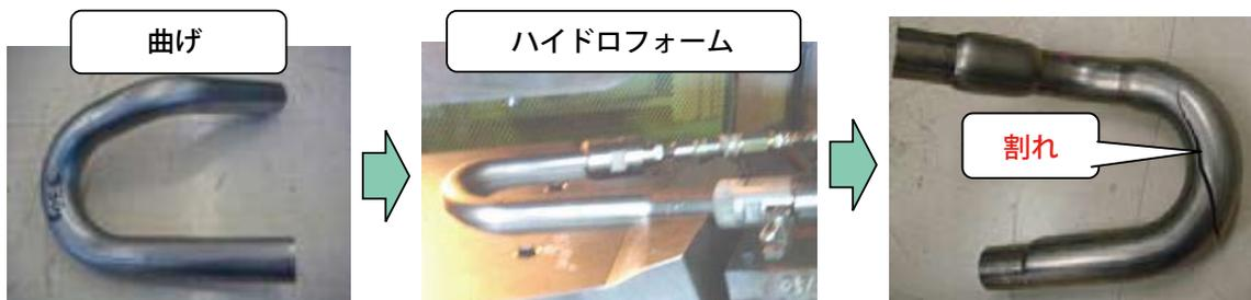
図7 ハイドロフォーム加工時の不具合
