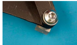
図 14 塩水噴霧試験後の締結部外観
