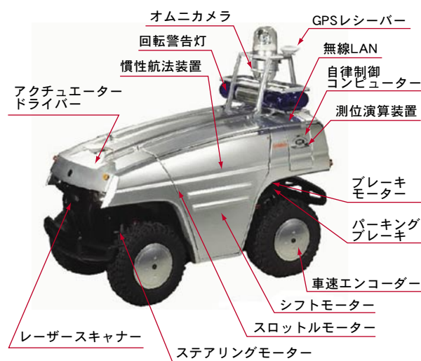
図3 UGV搭載の制御装置
