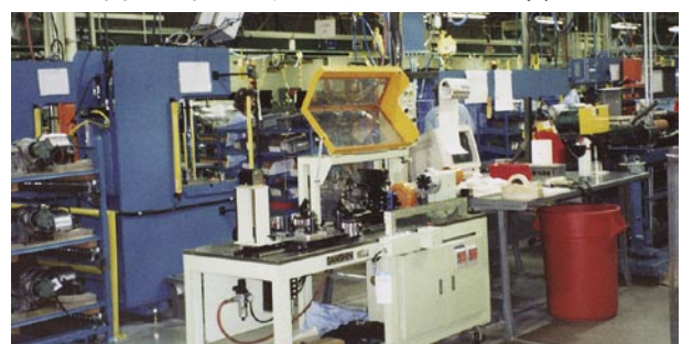
図 18 YMMC に設置されたジェットポンプ組み立てライン
