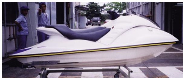
図 20 軽量 SMC 採用艇の GP1200R 試作艇
