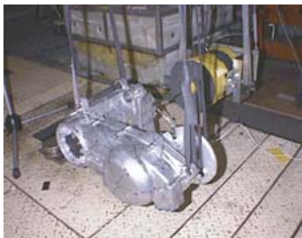
図5 実験：ボイドエンジン Shaker 加振
