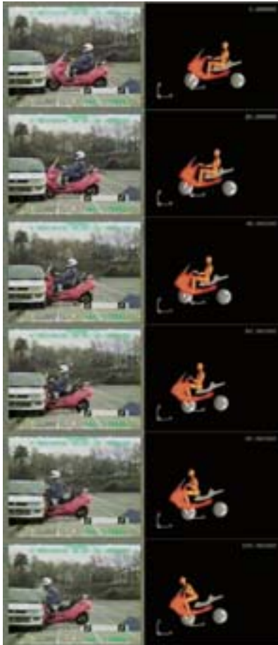
図2 二輪車衝突シミュレーションの実施例 -エアバッグなしの場合-
