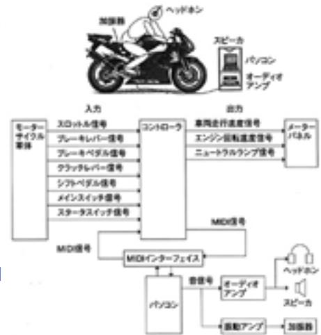
図 11 サウンドシミュレータの構成
