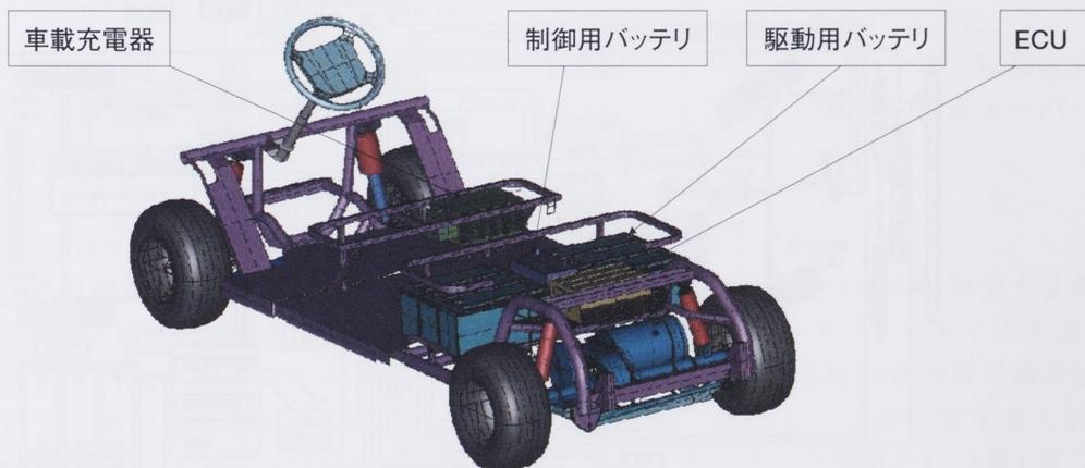
図2 バッテリー配置等の斜視図
