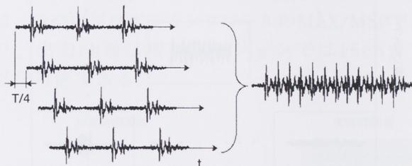
図5 多気筒エンジン音の合成方法
