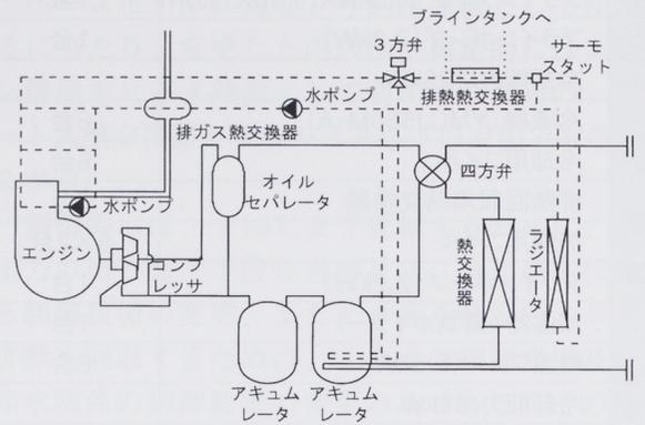
図4 エンジン排熱回収回路概略図
