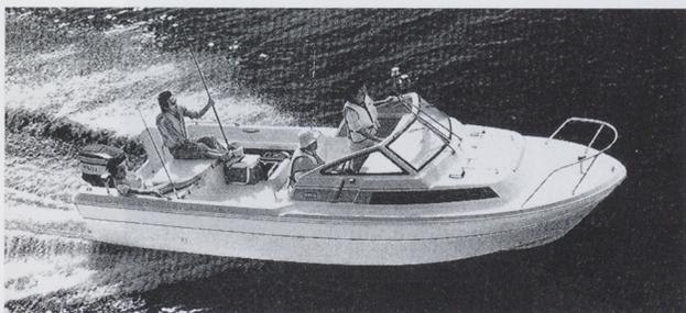
図13 滑走型和船船型
