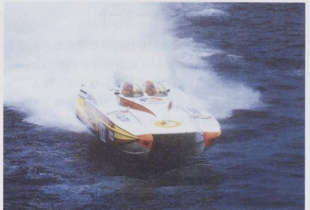
図8 ステップ付きのトンネルカタマラン
