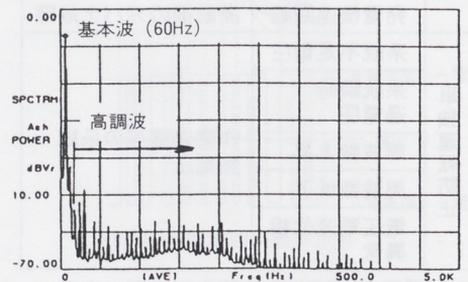
図11-(b) 電流波形, 高調波スペクトル
