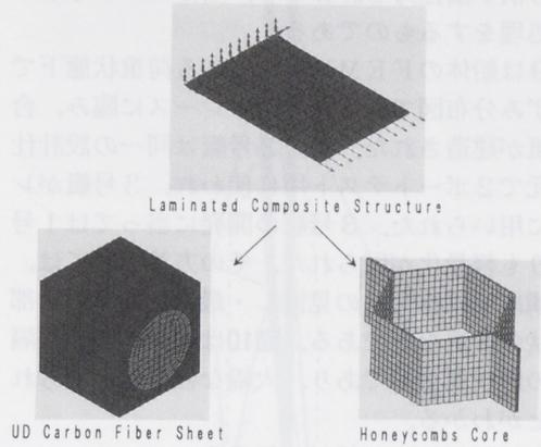
図5 均質化法の処理フローと計算モデル
