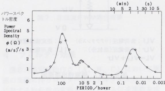
図10 風速のパワースペクトル
