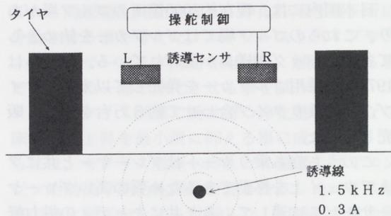
図3 電磁誘導のしくみ
