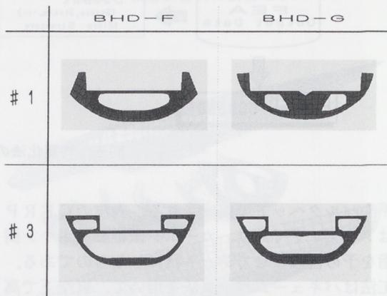
図10 バルクヘッドの形状変更例
