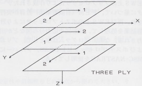
図3 積層複合材の計算モデル
