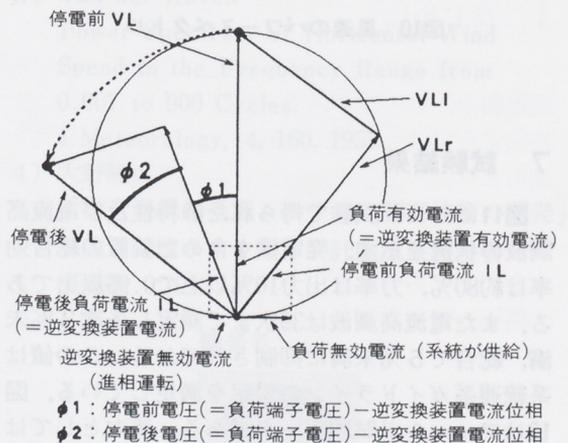
図9-(b) 停電検出原理図
