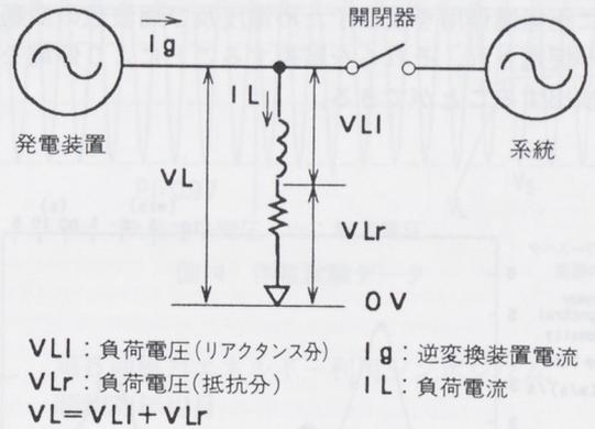
図9-(a) 停電検出原理図
