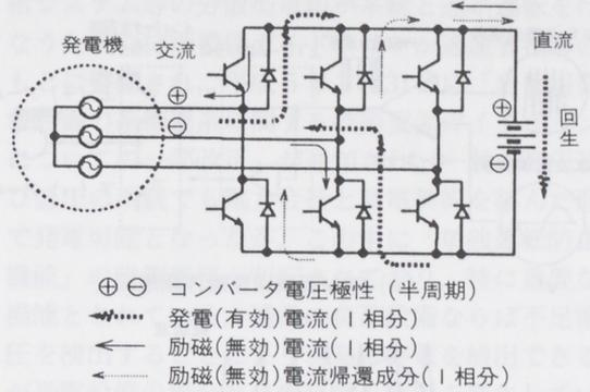
図5 順変換装置電圧、電流分布
