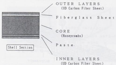
図6 AC艇の船体構造
