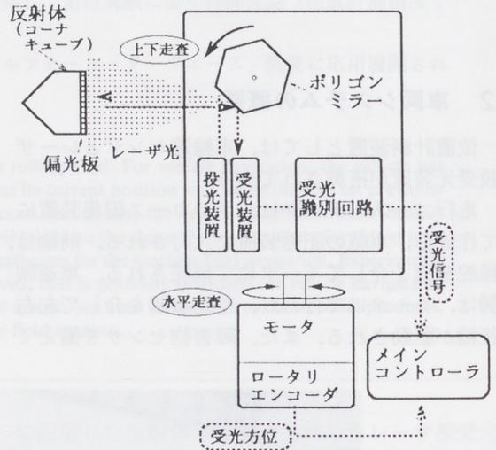
図4 レーザー投受光器の仕組み
