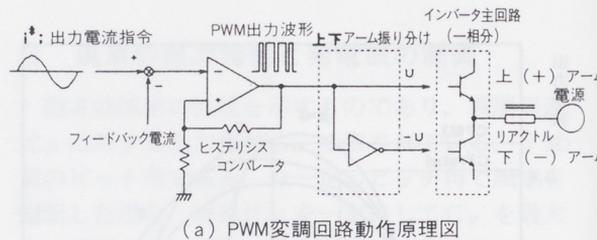
(a) PWM変調回路動作原理図
