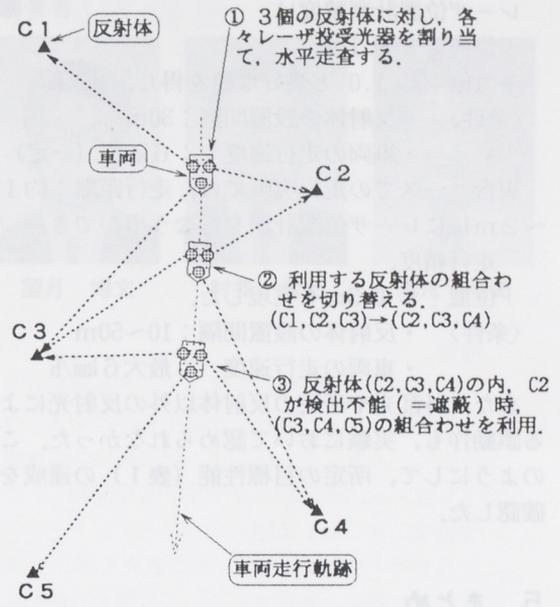
図6 利用反射体の切り替え
