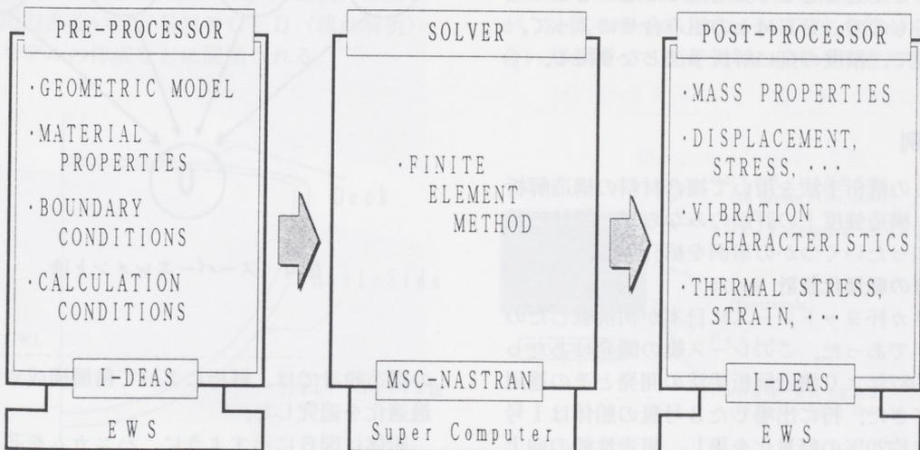
図2 構造解析プログラムの処理フロー
