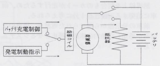
車両停止時も同様に発電ブレーキにより制動を行ない、停止後は電磁ブレーキによりパーキングロックさせている。
