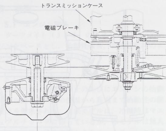
図8 ベルト変速機&電磁ブレーキ
