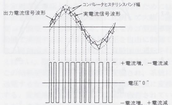
(b) PWM変調回路動作波形
