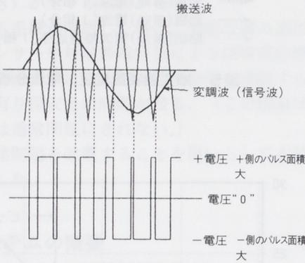
(b) PWM変調回路動作波形
