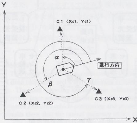
図3 従来の位置計算原理 (静止状態)
