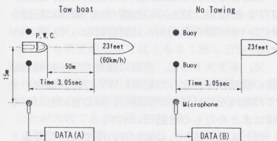
図10 造波音測定方法の概略
