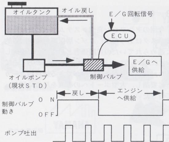
システムは、エンジン側とタンク側戻しへの通路を切り替える制御バルブとそれをコントロールするコントロールユニットで構成される。図で解るように一定回転でオイルポンプは一定間隔でオイルを吐出している。制御バルブは決められたO
