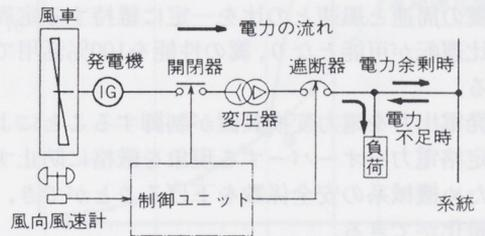
図1 一般的な風力発電システム
