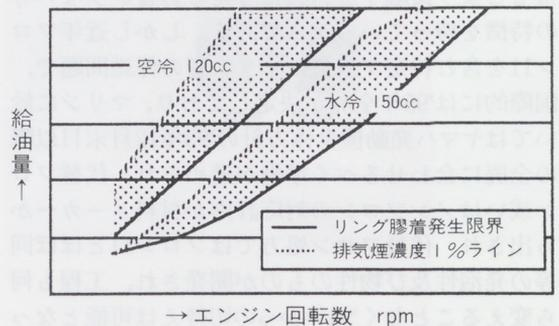
上のグラフにYCLSでの設定例をしめす。基本的に排気煙も見えずリング膠着も発生しない給油量領域がある。この中に給油量を合わせるのがYCLSである。心配される潤滑トラブル(ピストン焼き付き等)発生限界はリング膠着発生限界より更に給油量が少ない領域である。
