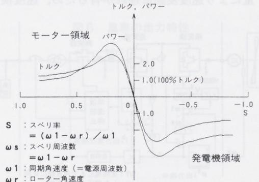
図2 誘導発電機原理図
