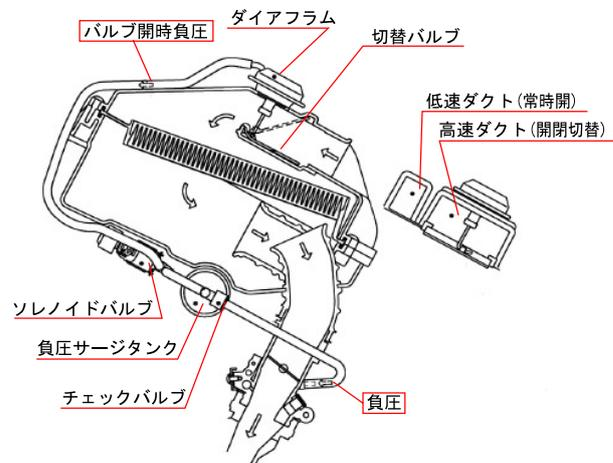
図5 可変吸気ダクト構造
