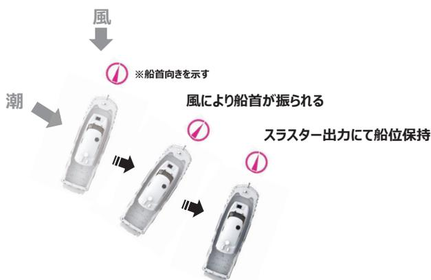
図6 e-COMPASS 設定時 船の動き
