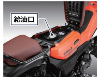
図6 給油のしやすさと積載性を考慮したシート構造
