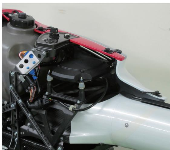
図5 新YARS (写真中央) 搭載図
