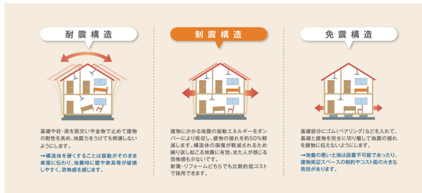
図1 耐震化構造の比較
