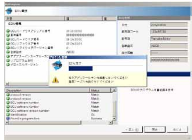
図10 コントロールユニットプログラム書換え
