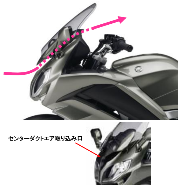
図5 センターダクト
