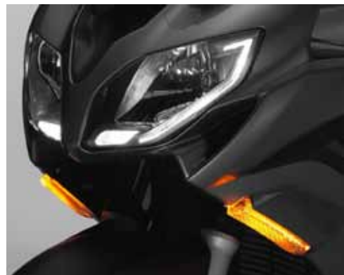
図9 アイライン状に輝くLEDポジションランプ
