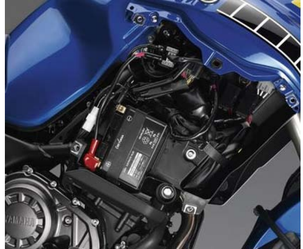
図6 電装部品の集中レイアウト
