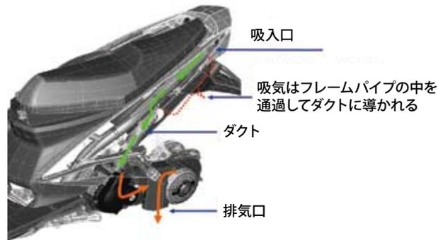
図2 ベルト冷却方式のコンパクト化
