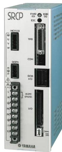
図8 ロボットコントローラー SRCP
