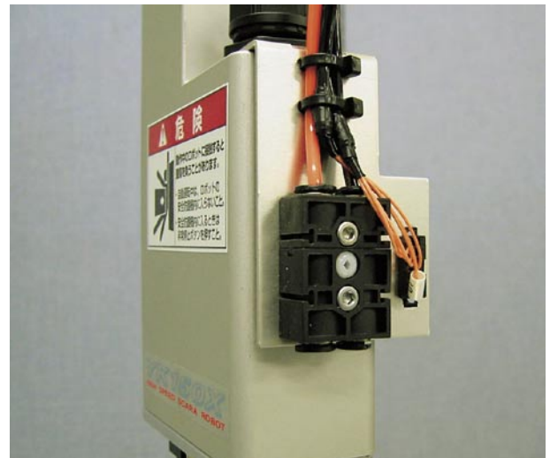
図4 ユーザー配線・配管
