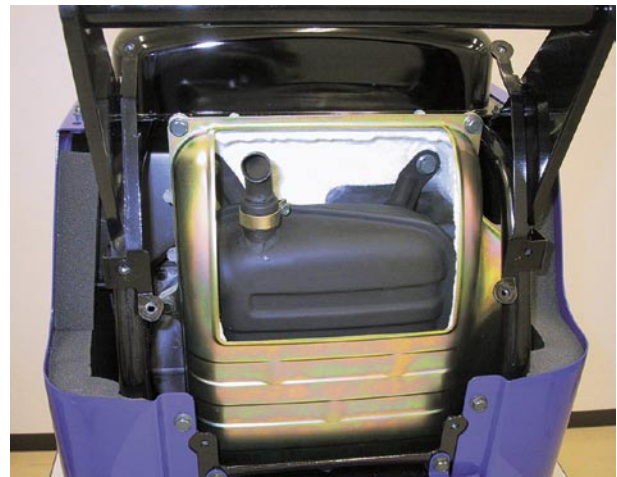
図6 マフラー部構造
