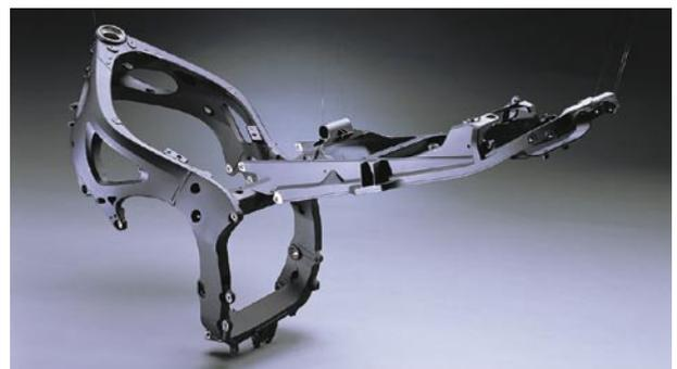
図 5 ダイキャスト製デルタボックスIIIフレーム
