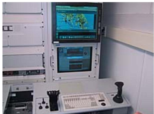
図4 PRADETOR の操縦システム
