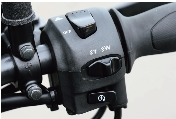
図7 可変色温度 ロービームの切替スイッチ
