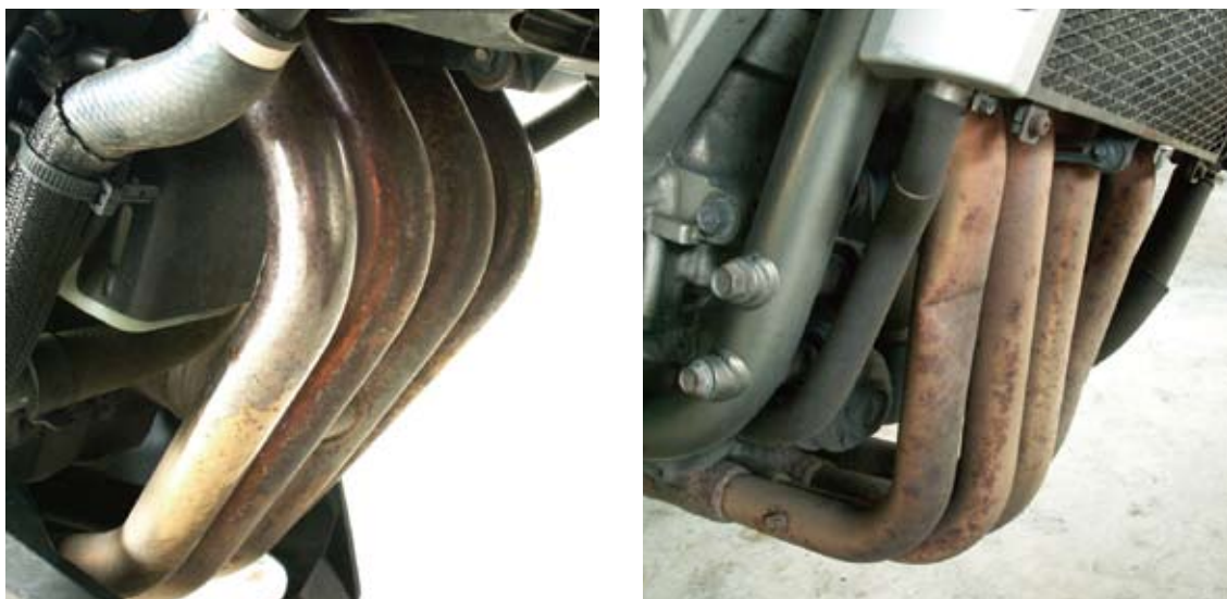
図1 変色や錆びが発生している二輪車の排気管
