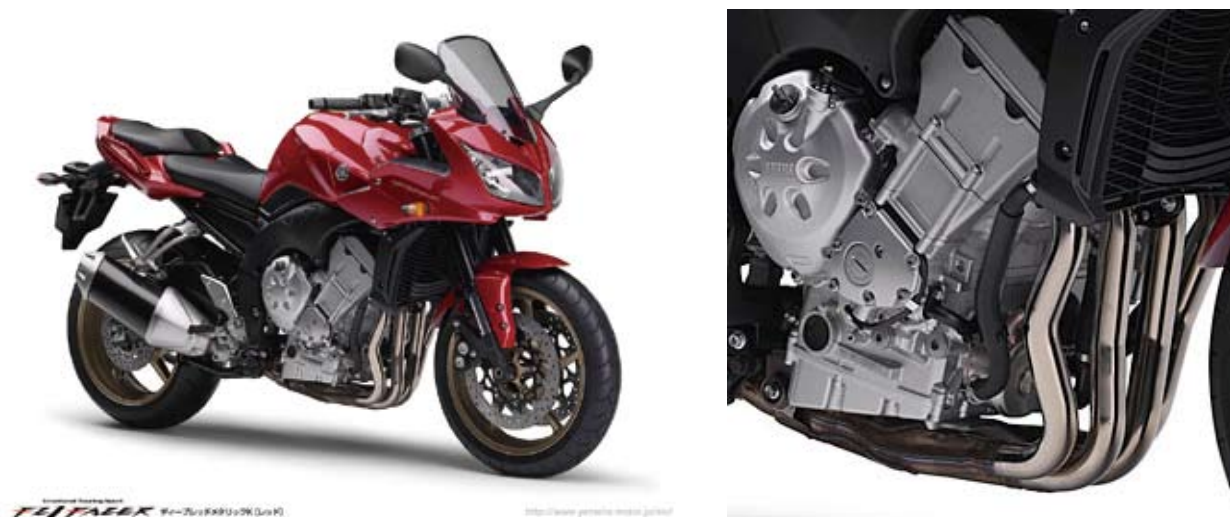
図7 ナノ膜コーティングの排気管を採用した FZ1「FAZER」
