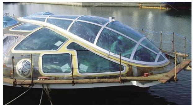
図6 船体に設置されたコックピットキャノピー
