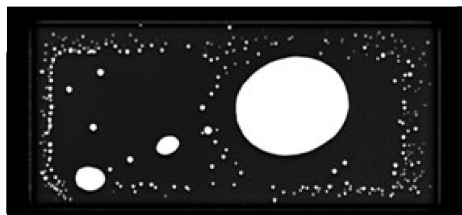
写真2-3 COW 接合後の接合界面の SAT 観察例
