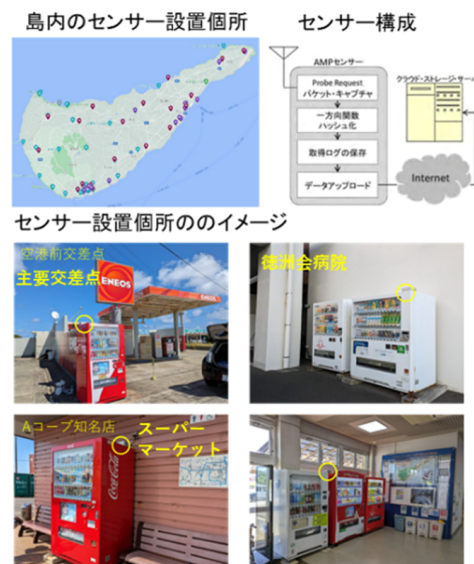
図3-1 パケットセンサの設置箇所・構成と設置状況
