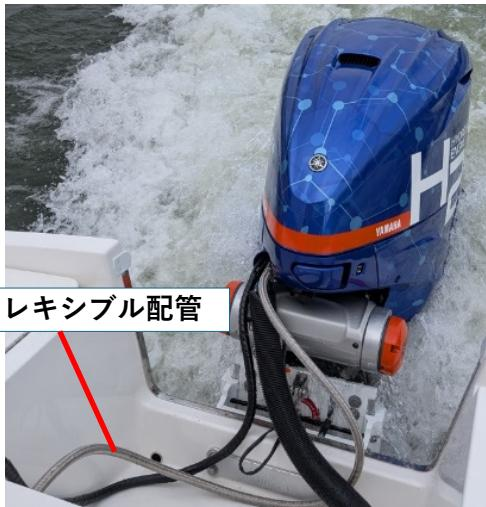
図23 水素フレキシブル配管の取り回し
