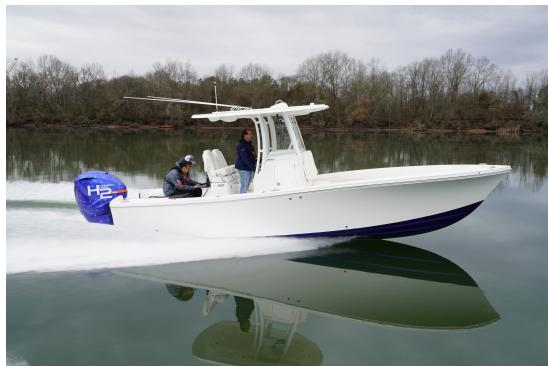
図27 水素船外機プレジャーボートの航走状態
