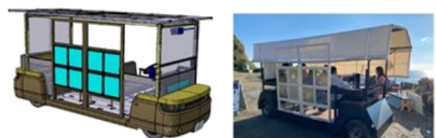
図9 V4: 地域資源などの循環素材を適用できる建築との共通モジュールを搭載可能なマウント構造を採用
