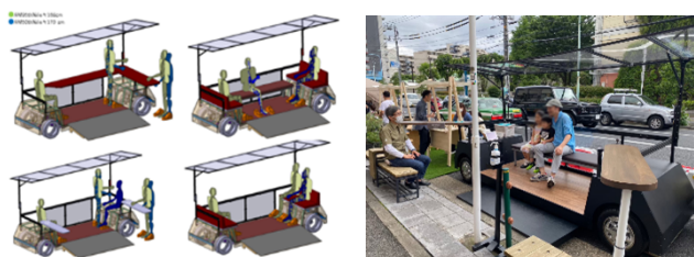
図6 V1: 中古カートを改造し、取り外し式シート・テーブル可変ルーフ等を装備
