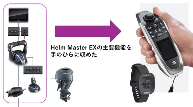
図1 ポータブル操船席コンセプト
