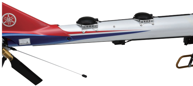
図5 2つの GNSS アンテナ(上)と磁気方位センサ(下)
