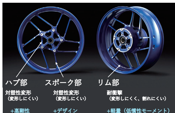
図1 キャストホイールの構造と要求機能
