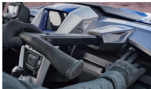
図9 多段階調整のパッセンジャーアシストグリップ
