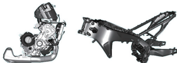
図2 エンジン及び、フレームとリヤアーム
