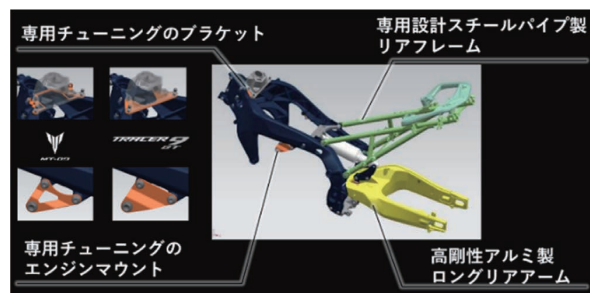
図14 共通フレームと専用設計のリアフレーム、リアアーム
