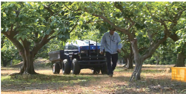
図17 LiDAR を用いた人追従
