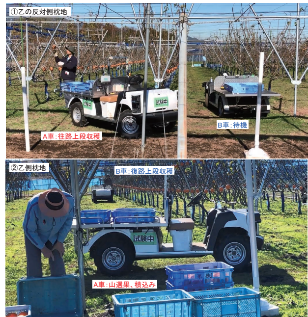
図14 2台連携収穫試験(①②は図13に対応)
