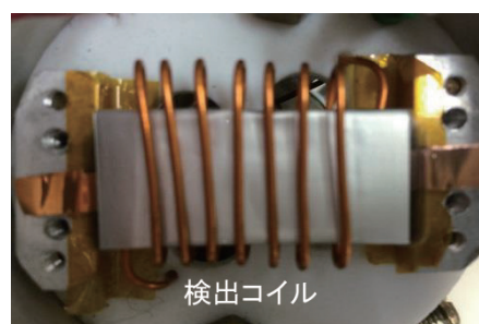
図3 電池NMR用扁平巻き検出コイル
