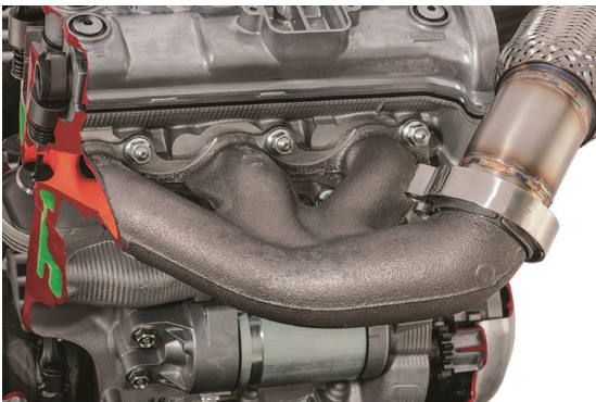
図6 耐熱鋳鋼製エキゾーストマニフォールド
