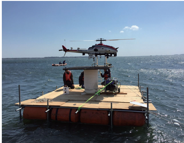
図2 船舶揺動安定装置の機能確認
