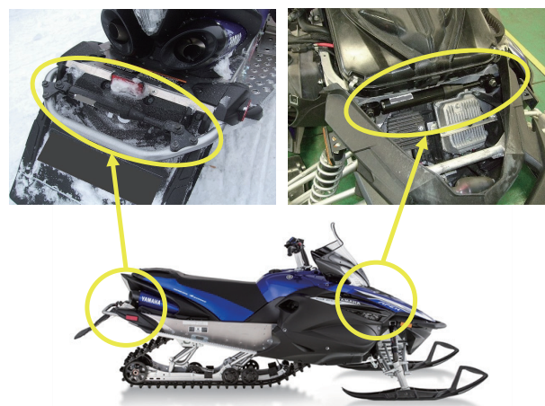
図9 スノーモビルへのPD取り付け例
