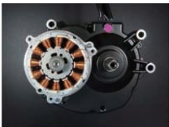
図12 12スロット14ポールのモータ部
