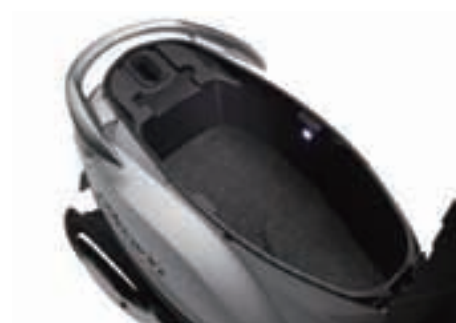
図7 LED照明付シート下ランク
