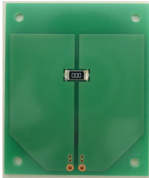
図5 チップ抵抗実装基板
