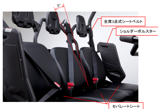
図4 フィット感、ホールド感を確保する分割シート
