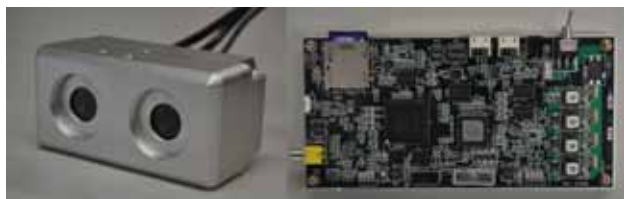
(a) ステレオカメラ (b) 画像処理ボード 図3 ステレオ画像認識システムのハードウェア
