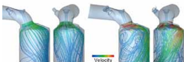
図5 YM-JET FI の効果(副通路有り無しによる筒内流動の差)
