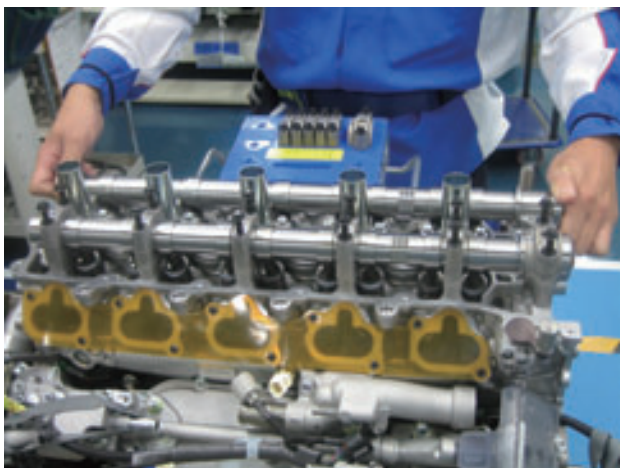
図10 ダミーカムシャフトによる芯出し
