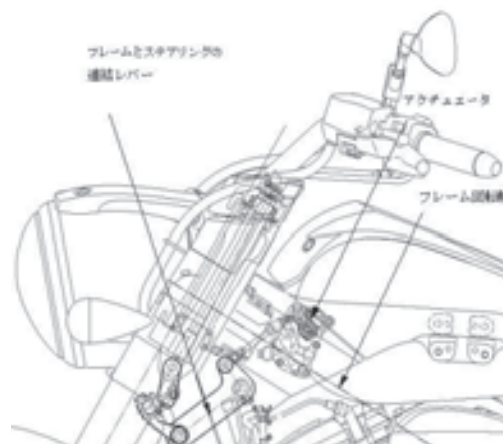
図3 二輪操舵機構詳細
